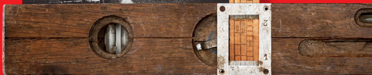
1949 — vodováha se sklonoměrem NT4 ze dřeva
